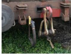
Ces conduites sont prévues pour être disposées sous la traverse de tamponnement.
