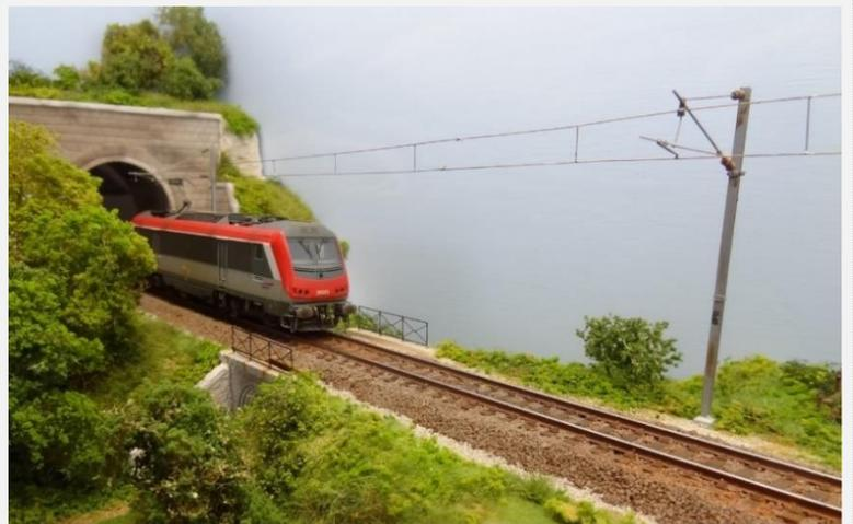
Supports caténaires pour le franchissement d'un tunnel : mise en place de 2 exemplaires de la réf 3604 permettant de réduire progressivement l'encombrement de la caténaire de 16 mm à 10,5 mm (support du 1er plan), puis à 3,5 mm (support près du tunnel).
