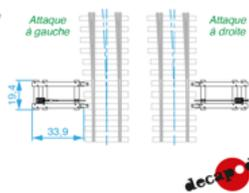
Réf 3451: levier d'aiguillage type L
