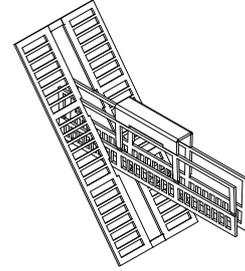
Placer les tenons situés au centre de la pièce 2 dans les ouvertures de la pièce 1.
