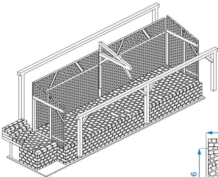
**Étape 5:** Décorer avant pose les pièces de la toiture (poutre, charpente). Poser la poutre centrale en l'insérant dans les échancrures des murs en briques. Poser ensuite la charpente qui est alignée par rapport à la poutre arrière et enfin la toiture en ardoises (attention au sens des ardoises !).
