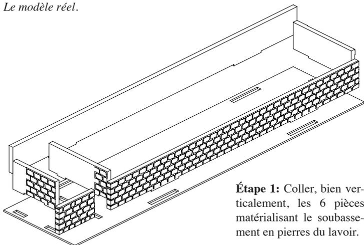
**Étape 1:** Coller, bien verticalement, les 6 pièces matérialisant le soubassement en pierres du lavoir.
