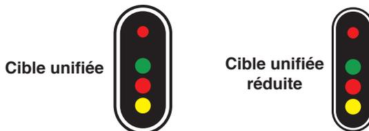
Déterminez le type de fixation en fonction du mât ou de la nacelle qui sera associé à la cible. Attention, seule la cible unifiée réduite peut être montée sur un mât léger.
