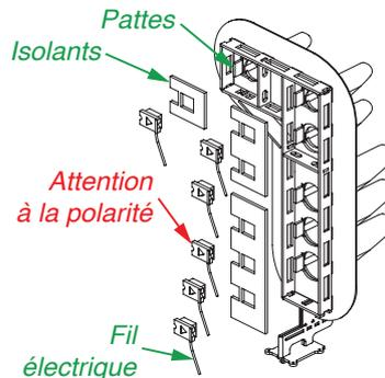
**Étape 4:** C'est le moment de passer au câblage des feux. Commencez par souder un fil électrique sur le **néga**tif de chaque LED. Sa longueur dépend du type de support (mât, potence ou portique): par défaut il est livré 20 cm de fil par feu, et autant pour le commun. Puis enfiler la plaque d'isolant dans le chassis et soudez ensuite l'autre borne des LED sur les pattes de ce dernier.
