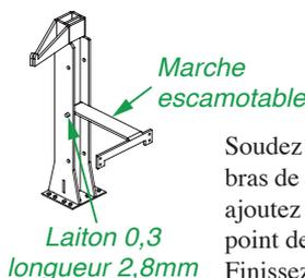
Soudez l'aile en forme de T avec l'âme. Repliez les bras de manière à aider à tenir la deuxième aile et enfin ajoutez la platine. Joignez l'extrémité des bras par un point de soudure. Finissez en pliant et soudant la marche escamotable sur le fil Ø0,3mm.
