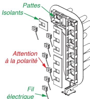
**Étape 4:** C'est le moment de passer au câblage des feux. Commencez par souder un fil électrique sur le **néga**tif de chaque LED. Sa longueur dépend du type de support (mât, potence ou portique): par défaut il est livré 20 cm de fil par feu, et autant pour le commun. Puis enfiler la plaque d'isolant dans le chassis et soudez ensuite l'autre borne des LED sur les pattes de ce dernier.
