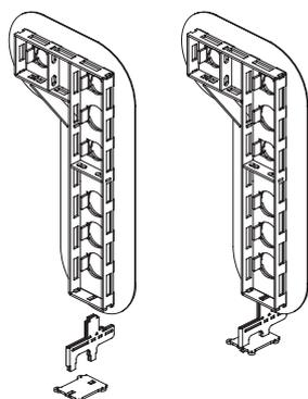
**Étape 2:** passons au dispositif d'orientation. Il suffit de replier sur lui-même le secteur d'orientation et de le souder au reste.
