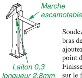
Soudez l'aile en forme de T avec l'âme. Repliez les bras de manière à aider à tenir la deuxième aile et enfin ajoutez la platine. Joignez l'extrémité des bras par un point de soudure. Finissez en pliant et soudant la marche escamotable sur le fil Ø0,3mm.
