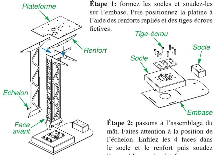
**Étape 1:** formez les socles et soudez-les sur l'embase. Puis positionnez la platine à l'aide des renforts repliés et des tiges-écrous fictives.
