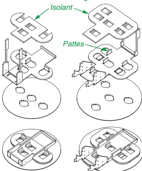
**Étape 1:** formez le châssis et positionnez-le sur le panneau en vous aidant des trous des feux, puis soudez l'ensemble. Attention de bien glisser l'isolant avant.
