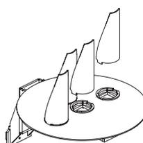
**Étape 3:** formez les parasols en vous aidant d'une queue de foret de Ø2 mm pour la version Ø160, puis soudez-les sur le panneau. Si nécessaire, il faudra réduire la longueur des tenons des parasols pour obtenir un bon ajustement.
