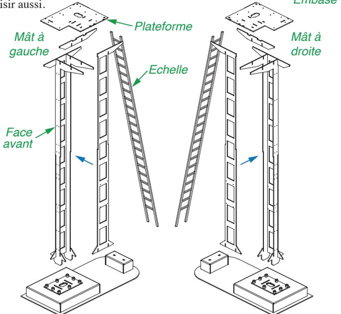
**Étape 3:** le choix de la lice de protection dépend du type de cible et en fonction d'un mât à gauche ou à droite. Pour former le pli, aidez-vous de la queue d'un foret de Ø1,4 mm. Sur la planche B qui comporte ces pièces, des triangles repèrent l'endroit où former la lice pour les cibles F ou H.
