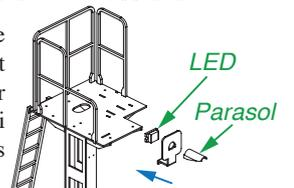
Formez le parasol à l'aide d'une queue de foret de Ø1 mm. Cette pièce se trouve sur la planche 4000-A fournie dans les kits de cibles. Ensuite, pliez le support d'oeillon, toujours en fonction du mât (gauche ou droite), et enfin soudez l'ensemble au mât.
