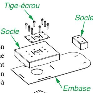
**Étape 2:** passons à l'assemblage du mât. En fonction du choix de l'implantation (à gauche ou à droite), il faudra orienter les faces avant et arrière, et positionner les faces latérales en conséquence. Le modèle de plateforme est à choisir aussi.
