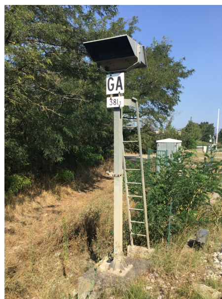
Guidon d'arrêt en gare de Meyrargues au Pk 381.3 de la ligne Veynes-Marseille
