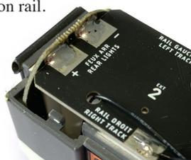
**Étape 6 (optionnelle):** le cavalier pour les feux arrières doit s'insérer autour de la porte dans la rainure prévue à l'extrémité de la caisse. Il tiendra par soudure sur la réglette. Vous pouvez bien entendu équiper les 2 extrémités au besoin.
