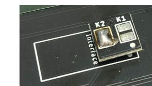
**Étape 6 (optionnelle):** si vous souhaitez allumer en permanence les feux de fin de convoi d'une extrémité, il faut ponter par un plot de soudure les pads correspondant sur le bouchon (K1 pour l'extrémité 1 et K2 pour la 2). Vous pouvez aussi remplacer ces plots de soudure par un ou plusieurs interrupteurs miniature (ref 6420) placés sous le châssis et reliés par des fils aux pads correspondants du bouchon.
